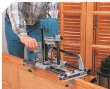
Arbeiten in waagerechter Position: besonders effektiv beim Fräsen mehrerer Langlöcher.
