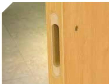
Fräsen von Schlosskasten und Stulp: Hilfsanschlag für Schloss und Drückerloch. Auch bei Türen mit Falz oder Überlappung (außermittige Position).
