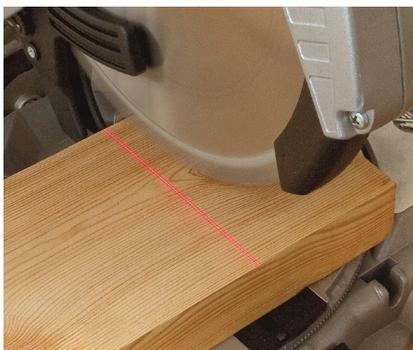
Ausgestattet mit einem Präzisionslaser. Automatisches Einschalten beim Maschinenstart. Mit Ein-/Ausschalter zum Abschalten bei Arbeiten am oberen Tisch.
