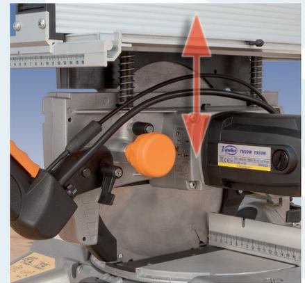
Neues Höheneinstellungssystem des oberen Tisches zur präzisen und stufenlosen Einstellung der Schnitthöhe.
