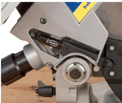
Stufenlose Bewegung dank des neuen leistungsstarken Gasdruckdämpfers.
