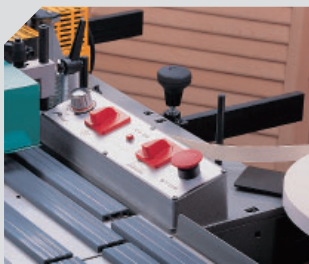
Not-Aus sowie elektronische Temperaturregelung.
