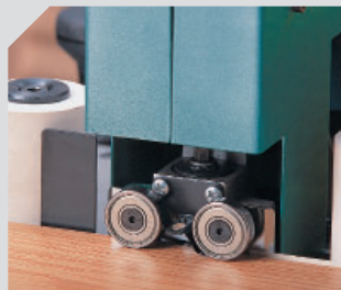
Fräseinheit mit 2 kombinierten Fräsern (r = 3mm, Fase 10°).
