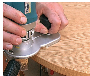
Kombifräsvorsatz (Sonderzubehör) für die Ecken- und Längskantenbearbeitung, auch an geschweiften Werkstücken.
