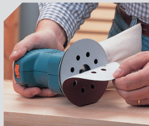
Anschluss an Staubabsaugung und Staubbeutel.
