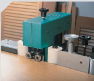
Sägeeinheit: sägt das Band an beiden Seiten gleichzeitig.
