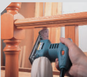
Bearbeitung schwer zugänglicher Flächen mit Delta-Aufsatz
