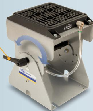
El sistema Auxiliar de Fijación SVN470 está formado por un Sistema Básico SVN250, montado sobre un Soporte Abatible. Permite el mecanizado de un borde y la cara de la pieza sin cambiar de sujeción. Se incluye también en el equipo, un sargento de apriete para la sujeción rápida del sistema SVN460 al banco de trabajo y un juego de tres juntas de goma de distinto perímetro. Disponible en opción el juego de 4 tornillos para el montaje de un SVN250 en la base (0999102)
