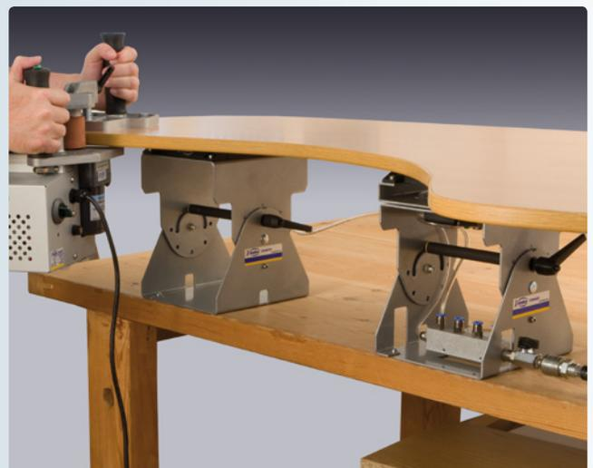
Sujeción de una pieza de grandes dimensiones con una unidad auxiliar SVN470 conectada al distribuidor del SVN460.
